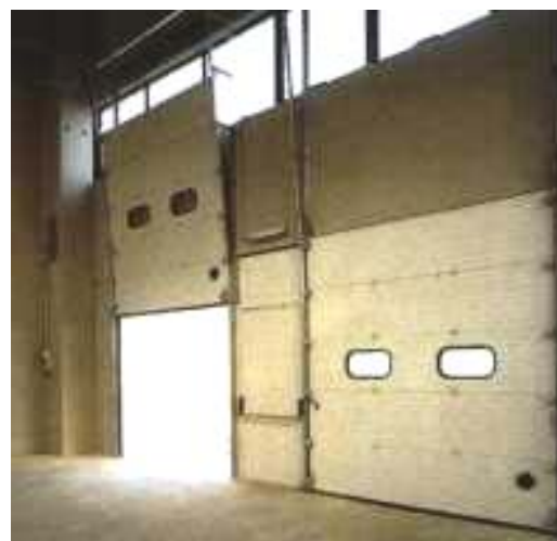
Industrijska sekcijnska vrata sa otvorima i sa pješačkim prolazom
